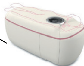
乳房用のリング型超音波画像診断装置「COCOLY」 検診受診者はうつ伏せになり胸を片方ずつ入れるだけ。 他人に触れられず、撮影技師のスキルに 依存せずに検診が受けられる。読影はAI(人工知能)を 活用した診断ツールを開発中とのこと
